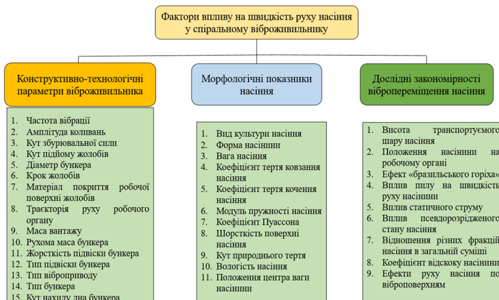
Рисунок 1 – Схема факторів впливу на процес вібротранспортування насіння спіральним віброживильником
