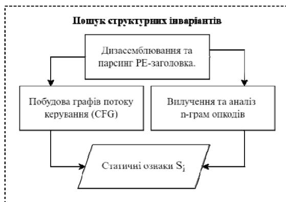
Рисунок 2 – Внутрішня логіка роботи Модуля 1: Статичний аналізатор
