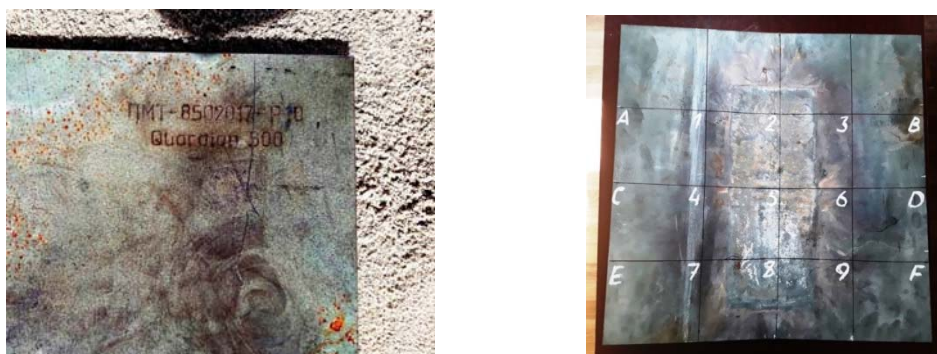
Рисунок 11 – Розташування вузлових точок контролю прогинів досліджуваної пластини Джерело: розроблено авторами
