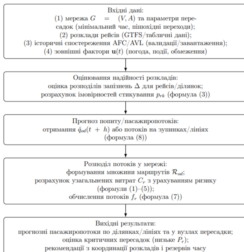
Рисунок 1 – Технологічна схема моделювання та прогнозування пасажиропотоків у мультимодальній маршрутній системі з урахуванням пересадок і надійності розкладів Джерело: розроблено автором
