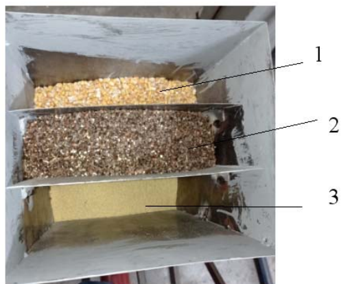
Рисунок 3 - Завантажені зерна кукурудзи 1, гречки 2 та проса 3 у бункер гвинтового конвеєра-змішувача у відділення між перегородками
