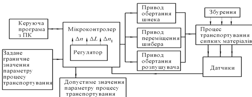
Рисунок 7 - Схема автоматизованої адаптивної системи граничного керування гвинтовим конвеєром із накопичувально-завантажувальним бункером
