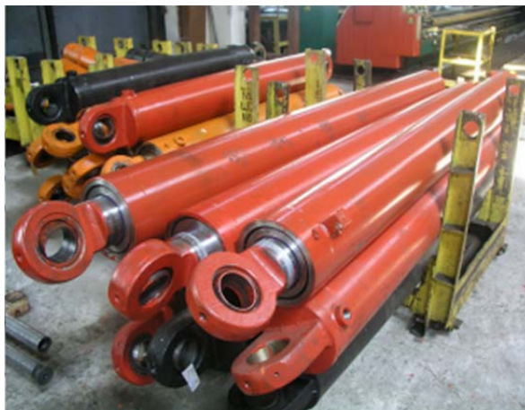
Рисунок 1 – Гідроциліндр плунжерний КС-4574.63.900 телескопування стріли автомобільного крана КТА-25
