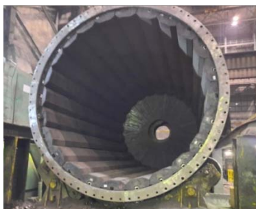
Рисунок 2 – Робоча поверхня барабанного млина, що облаштована гумовими футерувальними плитами (без ліфтерів)
