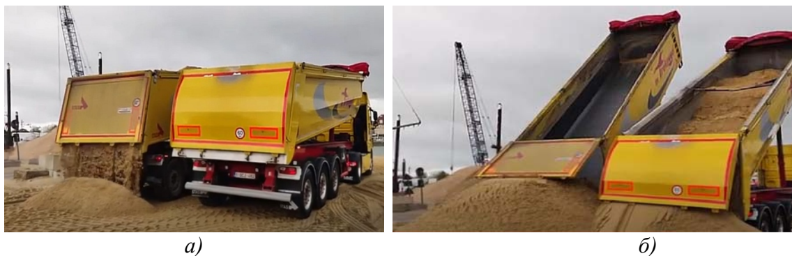
а) – початкова стадія розвантаження; б) - фінальна стадія розвантаження Рисунок 8 – Порівняльний процес розвантаження автосамоскидів, один з яких має футерування кузова еластомірним матеріалом
