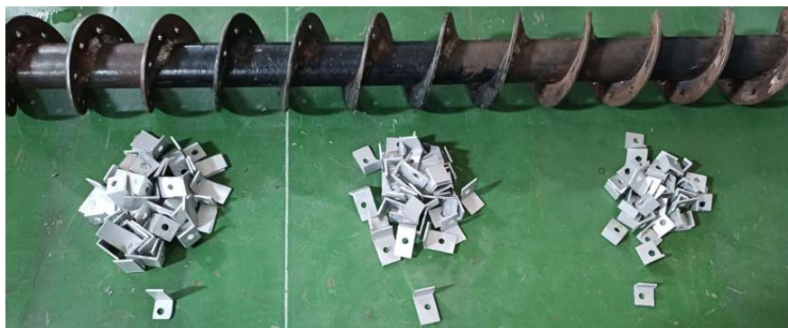
Рисунок 4 – Гвинтовий робочий орган з досліджуваними додатковими елементами
