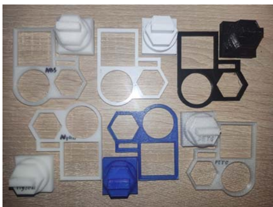
Рисунок 7 – Надруковані дослідні зразки з пластиків PLA, ABS, PET-G, PC/G та CoPET Джерело: розроблено авторами
