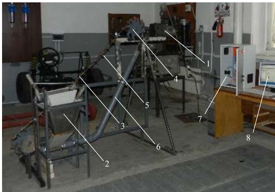
Рисунок 3 – Загальний вигляд лабораторного стенду для дослідження параметрів транспортування сипких матеріалів гвинтовим скребоквим трубчастим транспортером-змішувачем:
