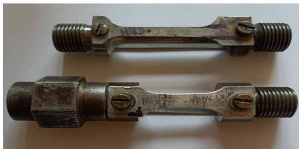
Рисунок 3 - Зруйновані від втоми зразки із сплавів ВТ1-0 і ВТ1-00
