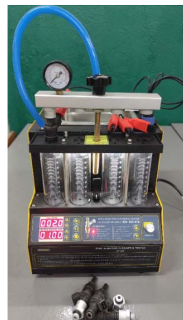
Рисунок 4 – Загальний вигляд стенду з форсунками перед початком діагностики.
