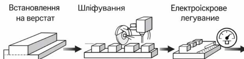
Рисунок 2 – Послідовність підготовки зразка до електроіскрового легування
