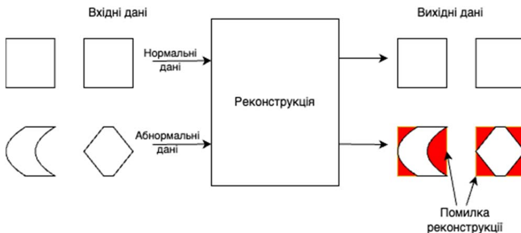
Рисунок 7 – Блок-схема знаходження аномалій бази даних методом реконструкції
