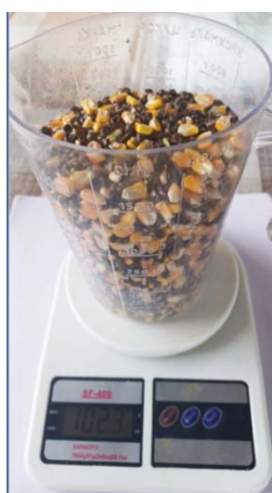
Рисунок 2 - Зважування зернових матеріалів після змішування
