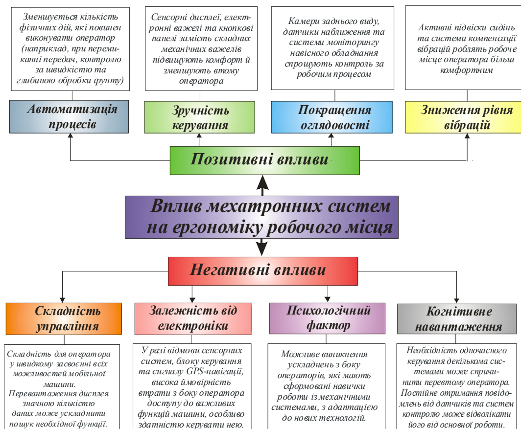
Рисунок 2 – Вплив рівня забезпеченості машини мехатронними системами на ергономіку робочого місця
