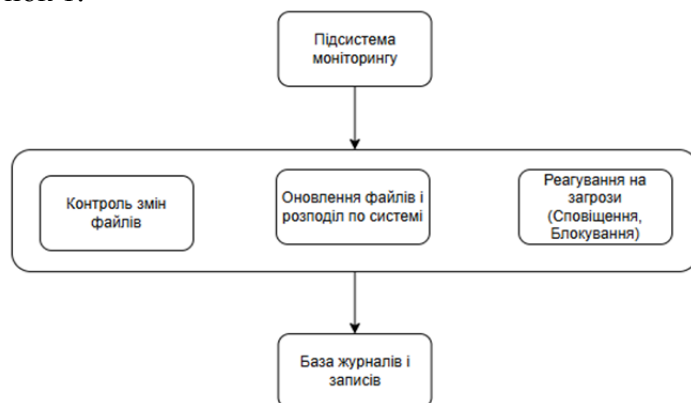
Рисунок 1– Підсистема автоматичного реагування на загрози
