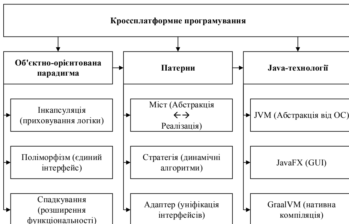
Рисунок 1 – Взаємозв'язок складових кроссплатформного програмування
