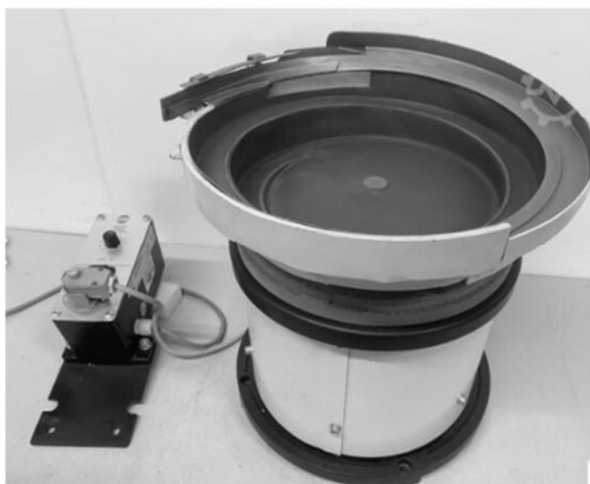
Рисунок 6 – Загальний вигляд вертикальних спіральних вібраційних машин: а – вібраційний конвеєр: 1 – вібраційний лоток; 2 – місце випуску транспортованої сировини; 3 – накопичувальний лоток сипких вантажів; 4 – вібропривод електричний; 5 – опорна рама; 6 – пружні елементи, б – спіральний вібраційний живильник
