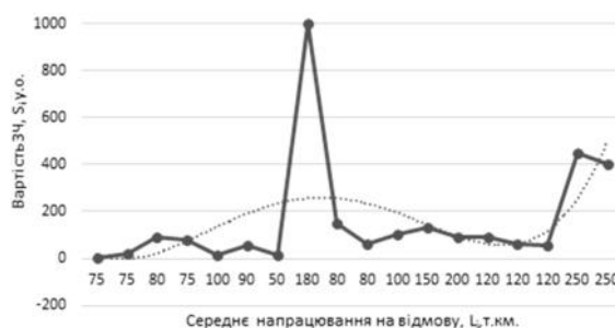
Рисунок 4 – Залежність абсолютних витрат на запасні частини від напрацювання на відмову автомобіля Renault Dokker
