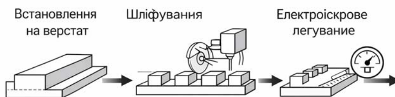
Рисунок 2 – Послідовність підготовки зразка до електроіскрового легування Джерело: розроблено автором
