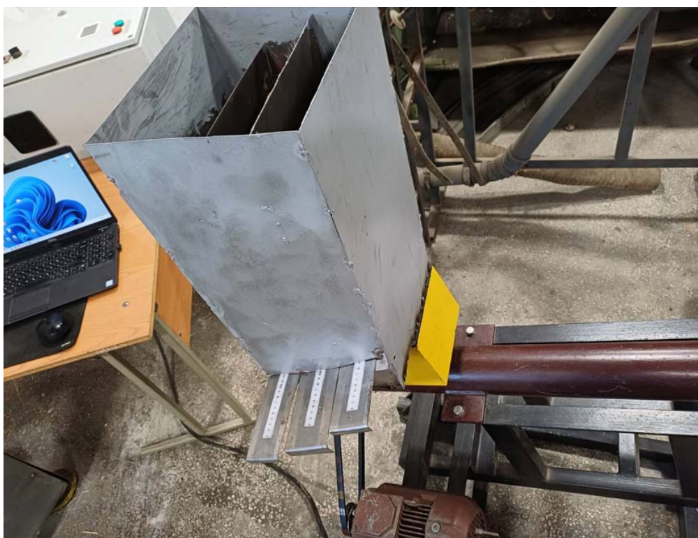
Рисунок 7 - Бункер регульованої подачі компонентів оснащений шиберами вимірювання подачі компонентів
