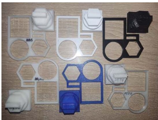
Рисунок 7 – Надруковані дослідні зразки з пластиків PLA, ABS, PET-G, PCTG та CoPET
