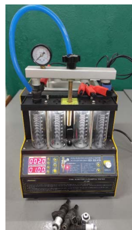
Рисунок 4 – Загальний вигляд стенду з форсунками перед початком діагностики. Джерело: розроблено автором
