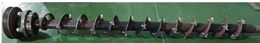
Рисунок 3 – Гвинтовий робочий орган оснащений досліджуваними додатковими елементами в підшипниковій опорі
