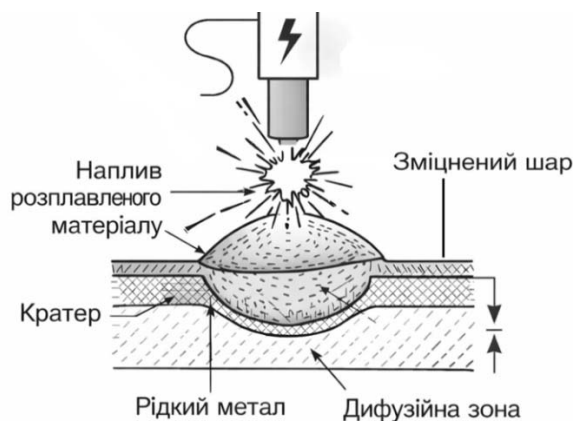
Рисунок 3 – Схема формування зміцненого шару при електроіскровому легуванні
