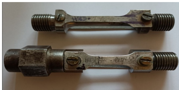
Рисунок 3 - Зруйновані від втоми зразки із сплавів VT1-0 і VT1-00
