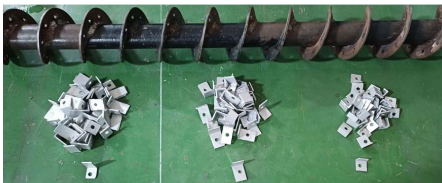
Рисунок 4 – Гвинтовий робочий орган з досліджуваними додатковими елементами
