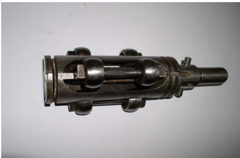
Рисунок 2 - Електрод-інструмент для нанесення покриття
